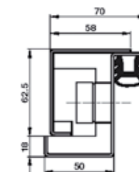
accoppiamento telaio e contro telaio
