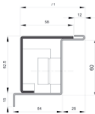
accoppiamento telaio e contro telaio
